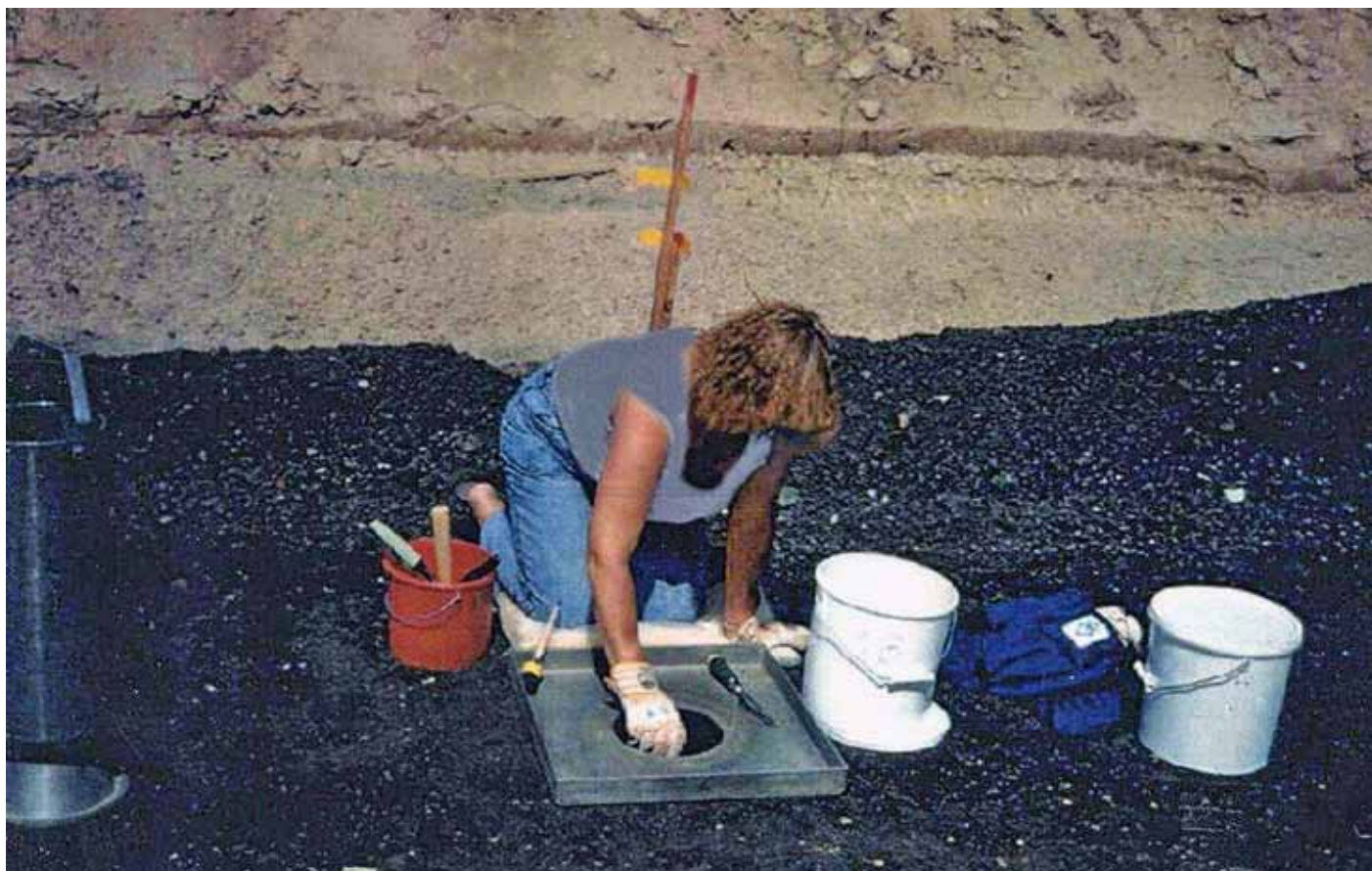
Figur 1. Komprimeringskontrol med sandefterfyldning på forbrændingslagge.
