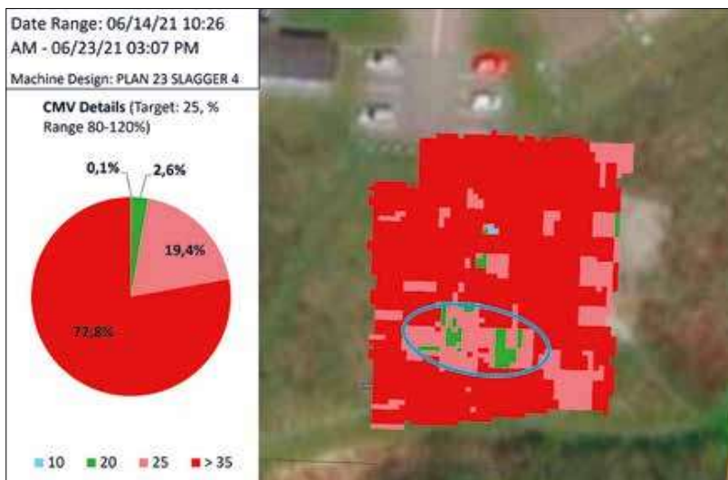
Figur 4: Plot af målte CMV-værdier efter fire komprimeringer af slaggegruslag fire. Target for CMV-værdien er arbitrært sat til 25 og range er sat til \pm 20\% . Ovalen (blå) viser området, hvor et elkabel blev gravet over, og hvor komprimeringen af underbunden er ringe. Den enkelte blokstørrelse med CMV-værdier er ca. 0,5 x 0,5 meter.
